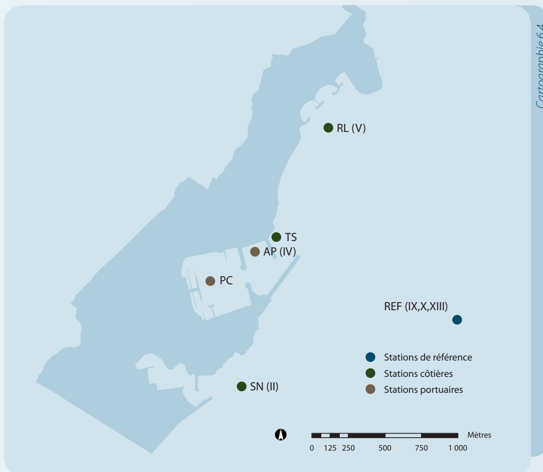
Points de mesure du programme de surveillance de la qualité hydrologique des eaux côtières
